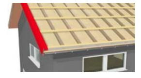
Après la pose de l'écran de sous-toiture imperméable, le contre-lattage est fixé sur les chevrons. Ensuite a lieu la pose du lattage transversal.
