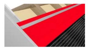
Une fois tous les panneaux montés, la tôle d'abergement supérieure est montée avec la tôle perforée supérieure....
