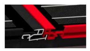
Ensuite, le second panneau coulisse dans le profilé de droite du premier panneau, puis dans le profilé de base monté sur le lattage, de la même manière que la pose des tuiles. Les autres panneaux du premier rang sont montés de la même façon. Pour le second rang, le montage recommence à gauche. Tous les panneaux sont montés les uns après les autres.
