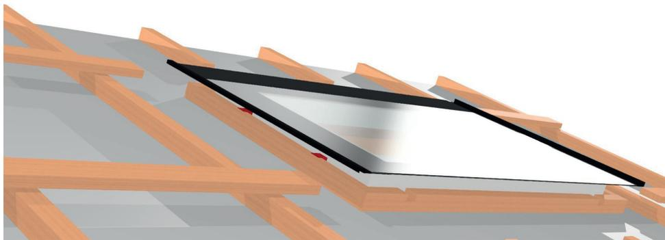
Posizionare quindi la finestra all'interno del telaio di controlistelli. La finestra si appoggia sugli angolari preinstallati del telaio, i quali determinano l'altezza corretta della finestra.
