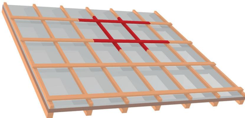
Misurare la posizione della finestra sul tetto e rimuovere controlistelli e listelli modulo in quell'area. Prevedere spazio sufficiente per collegare la membrana sottotetto alla flangia impermeabile attorno al telaio.
