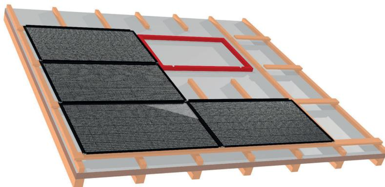
Montare l'impianto Arres 3.1 fino vicino all'area liberata. Posizionare il telaio di controlistelli e regolarlo con precisione come mostrato nelle figure successive.
