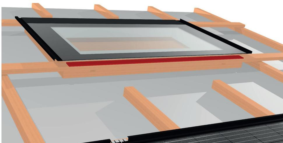
Fissare, nella zona della listellatura inferiore in corrispondenza del modulo situato sotto la finestra, una listella di legno spessa 8 mm (larga almeno 60–80 mm), a filo con il bordo inferiore della listellatura. Questa listella serve da supporto per il montaggio del modulo inferiore, che viene inserito sotto la finestra senza profilo di raccordo al tetto.
