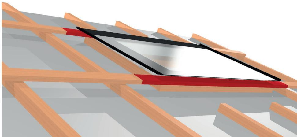
Avvitare ora i pezzi di listello precedentemente rimossi, situati sopra e sotto la finestra, al telaio di controlistelli, in modo che la listellatura dei moduli risulti nuovamente continua sul tetto.
