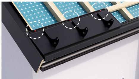
Contrôlez également ici la position correcte du profilé de fixation au toit du cadre, et retirez l'espaceur une fois le montage effectué.
