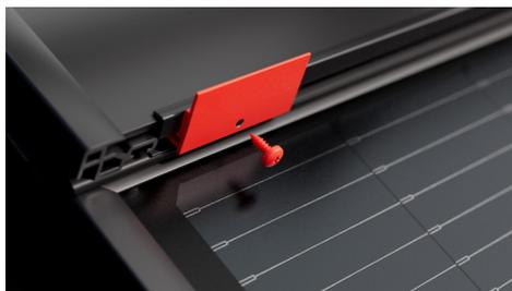
Fixez le support pour plaques de glace dans le profilé de cadre à l'aide de la vis à tôle correspondante. Serrez prudemment la vis et veillez à ne pas tourner excessivement.
