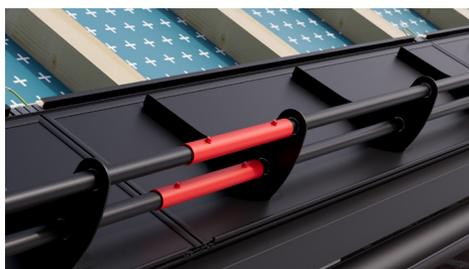
Si vous souhaitez agrandir les tubes, reliez-les avec les raccords de tubes d'arrêt de neige fournis. Veillez à ce que les tubes soient positionnés les uns à côté des autres sans qu'un écart ne se forme. Montez les raccords de façon à ce que les deux extrémités des tubes qui dépassent les raccords aient la même longueur. Cette longueur doit faire au moins 12 cm.
