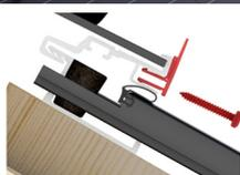
Pour les monter facilement, placez les griffes de fixation du dispositif arrêt-neige en position inclinée devant le profilé de cadre inférieur puis enfoncez-les dedans jusqu'à ce que vous entendiez un clic. Si nécessaire, il est possible de donner de légers coups dessus avec un marteau en caoutchouc.
