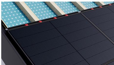
À l'aide des vis de fixation, de la rangée supérieure de panneaux, montez en même temps les 4 crochets de faitage.
