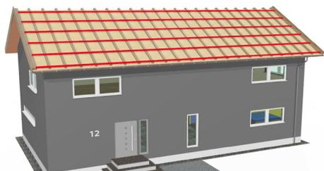
Vissez à présent le lattage du panneau sur le contre-lattage conformément à la planification de l'installation. Si nécessaire, nivelez les lattages de module. Les lattages de module droits et de même hauteur les uns sous les autres facilitent le travail et assurent l'étanchéité du système. Pour un montage aussi simple que possible, le lattage du module doit avoir des dimensions de 100x40mm. Du point de vue statique, la dimension minimale requise est de 80x24mm.
