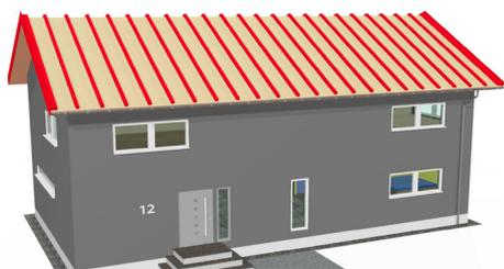
Vissez à présent le contre-lattage à l'abergement. Posez une bande d'étanchéité adhésive sur le contre-lattage pour une étanchéité parfaite de la sous-toiture.
