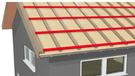
Veillez à ce qu'il y ait suffisamment de place pour les tôles permettant l'écoulement latéral de l'eau.
