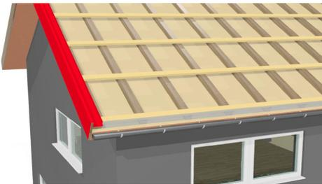
Veillez désormais monter les tôles permettant l'écoulement latéral de l'eau.
