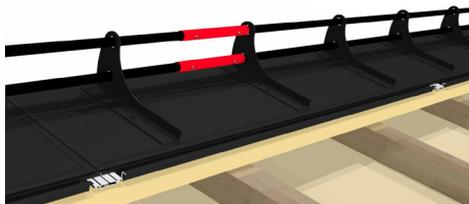
Si vous souhaitez agrandir les tubes, reliez-les avec les raccords de tubes de dispositif de retenue de neige fournis. Veillez à ce que les tubes soit positionnés les uns à côté des autres sans qu'un écart ne se forme. Montez les raccords de façon à ce que les deux extrémités des tubes qui dépassent les raccords aient la même longueur. Cette longueur doit faire au moins 12 cm.
