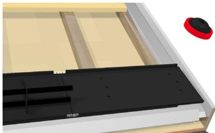
Au niveau de la bordure de l'installation, il peut être nécessaire de raccourcir les panneaux factices à dispositif de retenue de neige. Un dispositif de retenue de neige ne peut être installé sur ces panneaux en raison de leurs propriétés statiques.
