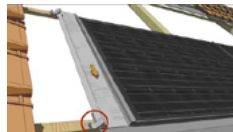
Puis fixez la tôle avec le crochet de fixation sur le lattage.
