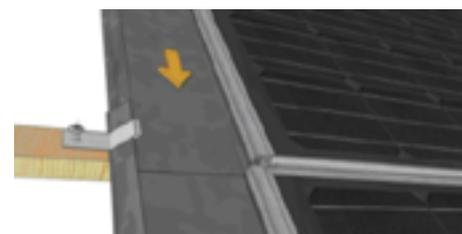
Installez la tôle d'abergement de la rangée de panneaux placée au-dessus en procédant de la même manière. Faites glisser la tôle d'abergement dans la partie sous-jacente, de sorte que le chevauchement soit d'au moins 8 cm.
