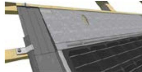
Setzen Sie das obere Anschlussblech wie abgebildet mit der unteren Umkantung in das linke Eckblech und die an den Modulen befestigen Firstblechhaken ein und verschrauben sie anschliessend mit den Befestigungshaken an der Holzlattung.
