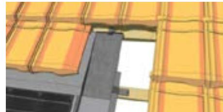
Schieben Sie zuletzt das rechte Eckblech in das Firstblech und das rechte Anschlussblech oder oberste Reihe ein und fixieren es mittels Befestigungshaken auf der Holzlattung .
