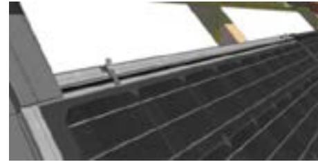
Befestigen Sie die Firstblechhaken bei der Installation der oberen Modulreihe zusammen mit den Tellerkopfschrauben (siehe auch Montageanleitung Arres 3.0)
